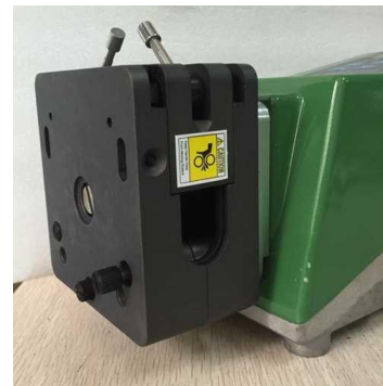
(2) 将泵头传动轴与驱动器联轴器对接，装上 3 个泵头固定螺钉，旋紧。
