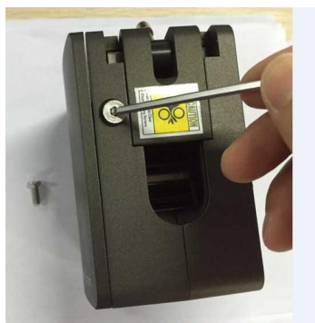
(1) 拆下前盖板 2 个固定螺钉，取下前盖板。
