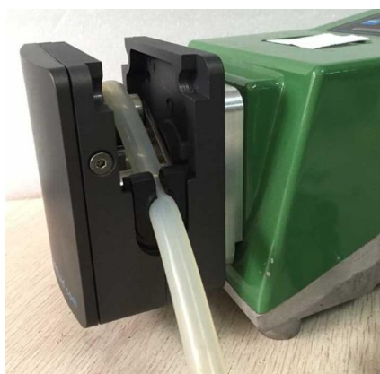
(5) 将两个管卡推入泵头的卡槽中同时用手将两侧的软管拉紧，使软管位于滚轮的中间位置。
