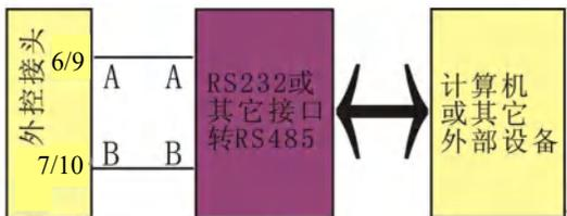
某些应用场合需要对多台蠕动泵进行远程通讯控制，可按上面“接线方式 4”将外控接口的 6/9 脚（A）和 7/10 脚（B）接出，组成如下
