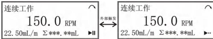
(二) 外控信号控制方向、启停，模拟信号控制转速。有以下两种控制方式，外控接口按“接线方式 3、4”接线。首先外控接口的 2、11 脚短接。
