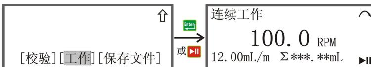
12.00mL: 设置的流量或根据设置转速生成的对应的流量, 即每分钟软管的输送量。
