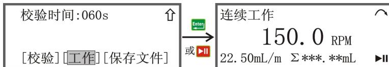
按提示准备可以容纳目标装量的容器及可称量目标装量的天平，按 **Max** 键将软管内充满液体，并确保软管内无气泡。然后按 **Enter** 键进入下一层菜单。装量校验界面按 **▶** 键，泵校验一次如下图。若已经知道了实际装量，可以按 **Enter** 键后直接输入实际装量值。
