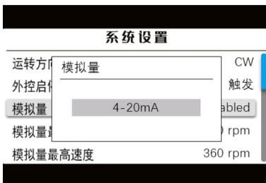
使用数字键盘输入模拟量最小值对应的转速，按 键可删除字符
