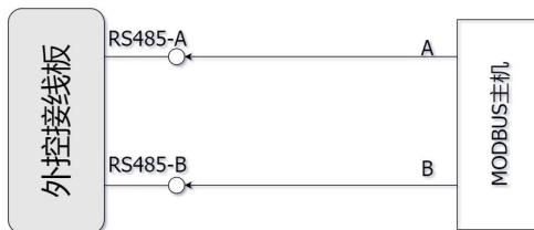
本机支持多从机集中控制，在多从机时，建议按以下拓扑结构接线，避免采用星形方式接线。
