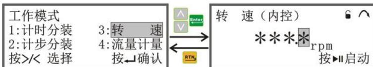
➤ ：表示键盘可操作；：表示键盘仅 键可操作。按 可设置锁/开锁键盘，如下图所示：
