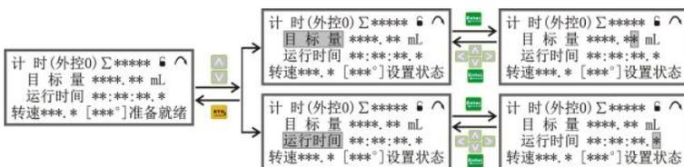
输入方法同手动/自动方式。“在外控1”时，“目标量”和“运行时间”也可以用通讯的方法进行设定。
