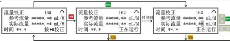
流量校正时间为 1 分钟，校正时倒计时，倒计时结束后将实际测量的数值输入并确认，校正完成。校正过程可反复进行。
