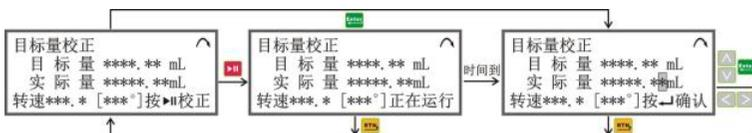
这里目标量校正的过程实际上是校正“转速”，先按设置的“运行时间”和计算出的转速运行，结束后将实际测量的数值输入并确认，
