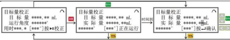
这里目标量校正的过程实际上是校正“运行角度”，先按设置的“运行角度”运行，结束后将实际测量的数值输入并确认，设备会计算出完成目标量所需准确的“运行角度”，校正完成。校正过程可反复进行。
