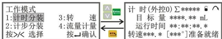
➤ 目标量 \*\*\*\*.\*\*\*: 输入的目标输液量，当输送液体到量时泵会自
