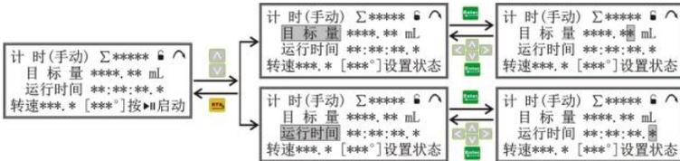
按 **[Up Arrow]** 键或 **[Down Arrow]** 键再按 **Enter** 键选择目标量参数，此时目标量参数末位数字反白，按 **<** 键或 **>** 键选择调节步进位，按 **[Up Arrow]** 键一次，步进位数值上调 1，按 **[Down Arrow]** 键，步进位数值下调 1，直至调节数值至所需值，再按 **Enter** 键确认。同样的方法可设置运行时间。设置完成后按 **RTN** 键返回“计时”工作界面。
