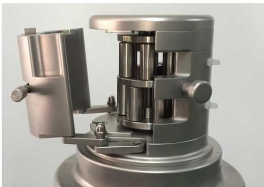
(3) 打开扳杆，两侧连杆机构向外张开，上压块用力拉出，使其与泵体脱开。
