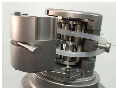
(4) 将两个 Y 型三通接头卡在两侧的管卡螺钉上。
