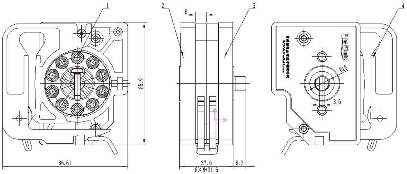
1. 滚轮组件    2. 前挡板    3. 后挡板    4. 卡片组件
